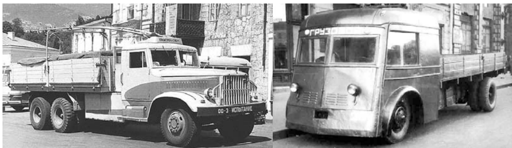
Trådlastbilar var inte ovanliga i de forna Sovjetstaterna. De används fortfarande till service och underhåll av system för trådbussar samt för leveranser av varor
